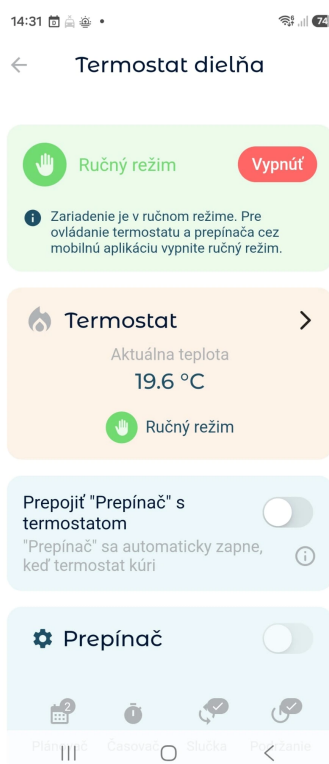
Obr. 5.2 - Ručný režim zariadenia v aplikácii AQUASPARK. Tlačidlom „Vypnúť“ ukončíte Ručný režim a umožníte riadenie cez aplikáciu.
